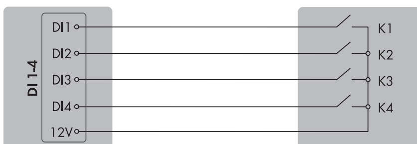
Afbeelding 21: Aansluiting van een ontvanger voor rimpelspanning op de digitale ingang DI 1-4 van de SMA eCharger die als System Manager moet worden geconfigureerd
